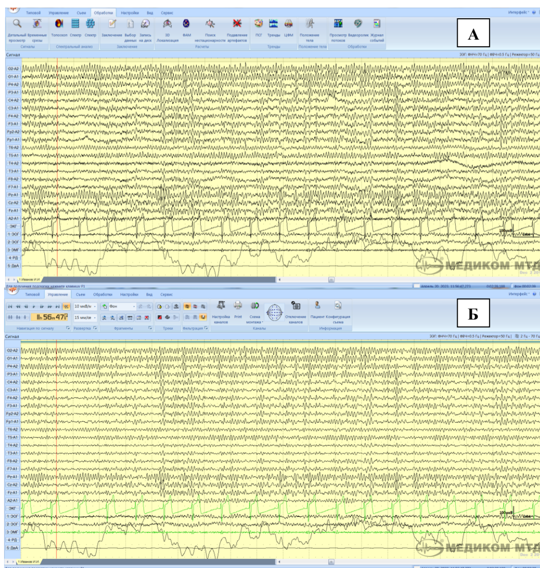
Рисунок 2.6 – Пример удаления артефактов нативной ЭЭГ. А) запись ЭЭГ до подавления артефактов; Б) запись ЭЭГ после подавления артефактов (заложенное в ПО)
