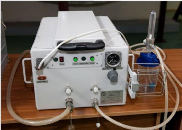
Блок адсорбционного концентрирования кислорода АГ-001
