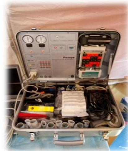
**Рис. 4. Мобильное устройство для комплексного обследования кардио-респираторной системы космонавтов**
