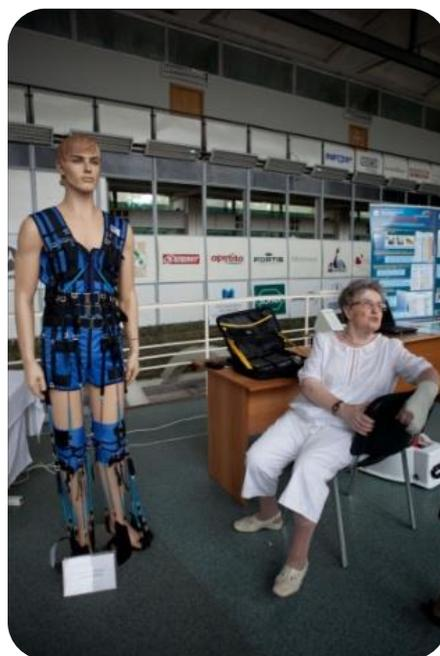
**Рис. 1. Костюм для принудительного изменения позы человека и создания повышенной нагрузки на опорно-двигательный аппарат**
