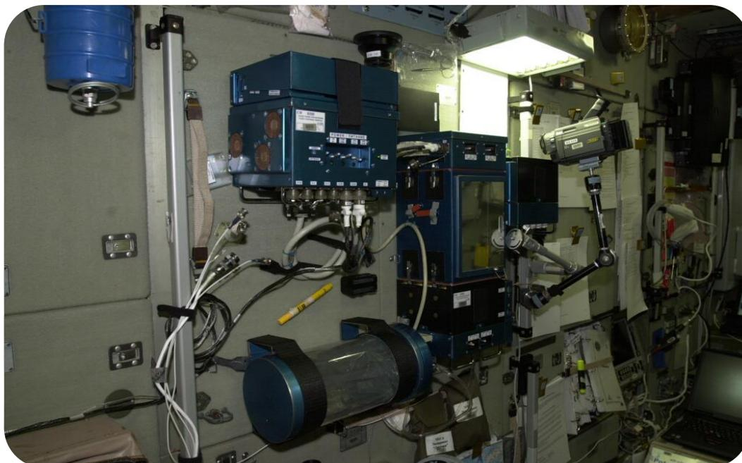
**Рис. 1. Оранжерея «Лада» на борту служебного модуля РС МКС.**
