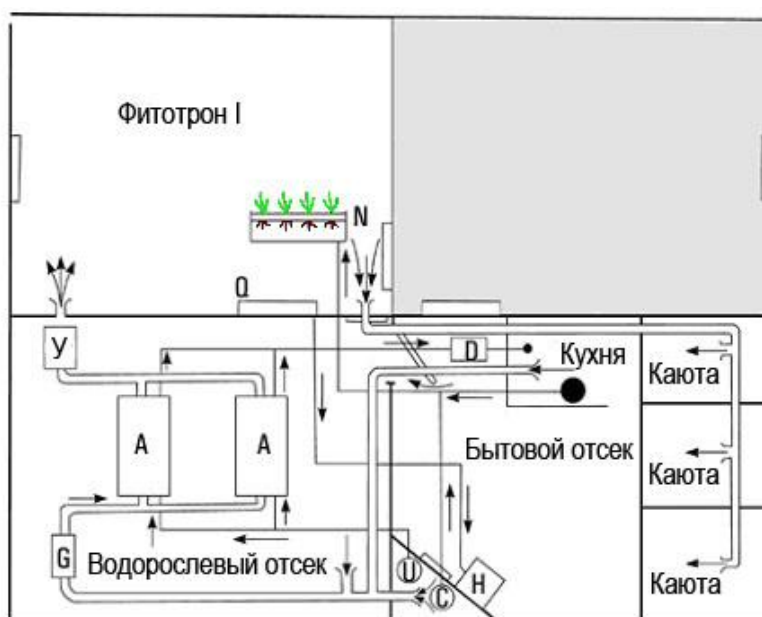
Рисунок 5 - Схема газо- и водообмена установки «Биос-3» на 2 М этапе эксперимента
