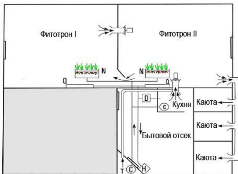
Рисунок 4 - Схема газо- и водообмена установки «Биос-3» на 1 М этапе эксперимента
