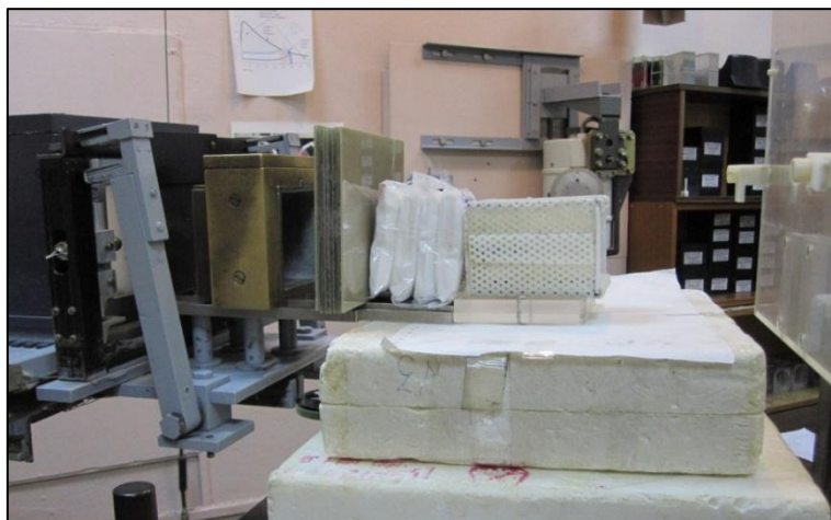
Рисунок 11. Использование конструкции из 4-х слоев гигиенических салфеток и 7-ми стеклянных фотопластинок
