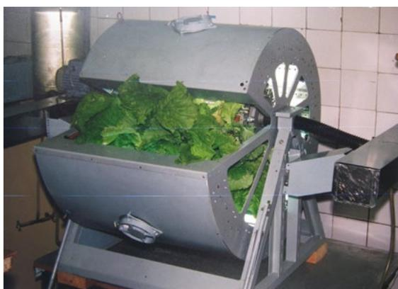
«Фитоцикл» - первый макет цилиндрической конвейерной оранжереи, построенной в лаборатории высших растений ИМБП
