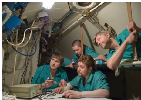
10-суточный гипербарический эксперимент по испытанию пожаробезопасной голокислеческой кислородно-азотно-аргоновой среды
