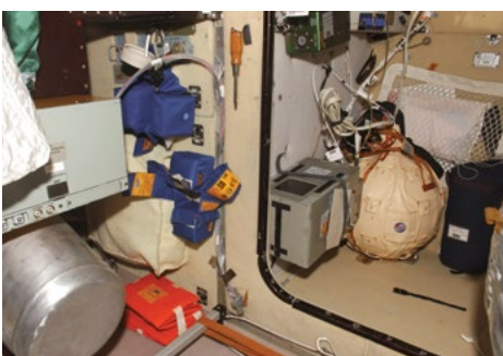
Шаровой тканезквивалентный фантом. Эксперимент «Матрешка-Р». 12-я экспедиция на МКС
