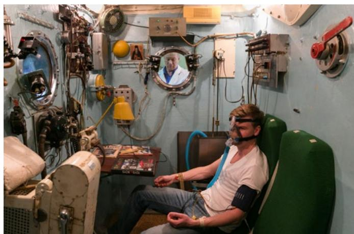
Врач наблюдает за подъемом испытателя на высоту до 5 км в барокамере ГБК-63 при дыхании гипоксическими искусственными газовыми смесями
