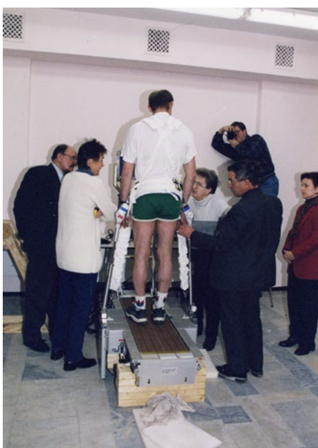
Специалисты ИМБП и «Энергии» проводят физиологические испытания макета бортовой беговой дорожки «Тивис». ИМБП, Москва, 2000 г Specialists of IBMP and Energy Corp. are carrying out the physiological tests using the simulator device TIVIS treadmill. Moscow, IBMP, 2000
