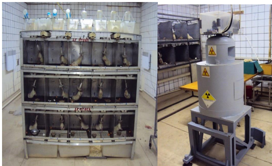
Рисунок 2 Общий вид экспериментальной установки для исследования синхронного комбинированного действия антиортостатического вывешивания (АнОВ) и длительного гамма-облучения на функции ЦНС крыс.
